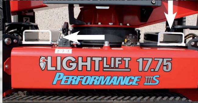
Pour transporter la machine Lightlift 17.75 PERFORMANCE on peut utiliser un chariot élévateur. Ce système est bien utile pour déplacer la machine sur le chantier et pour charger et décharger.
