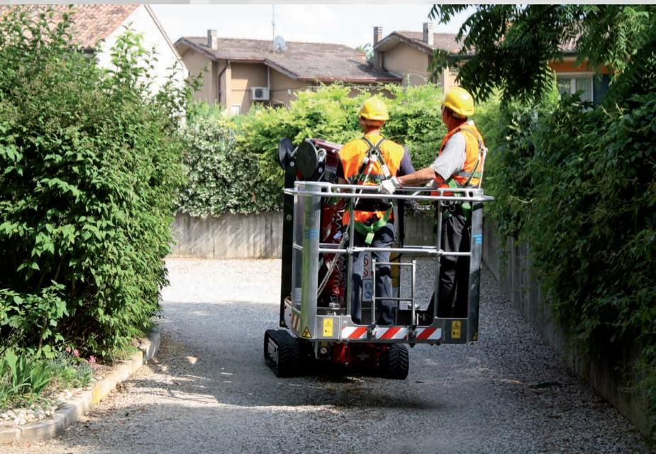
Le nouveau système Auto2Speed permet une translation plus rapide 3,6 km/h. En outre, grâce au contrôle sur l'inclinaison, la machine décélère automatiquement en condition extrême en toute sécurité.
